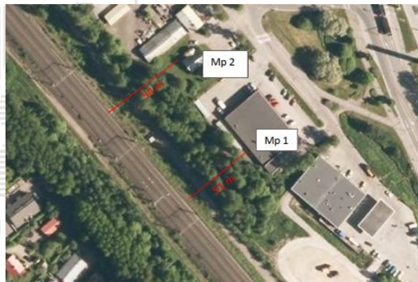
Kuva: ote Runkomelu- ja tärinäselvityksestä, kuva 3: Tärinämittauspisteiden suuntaa antava sijainti ja etäisyys radasta.
